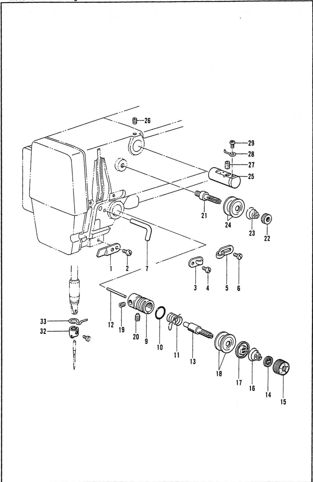
J. 糸通シ関係/Threading mechanism/Fadenführungsrichtung/
