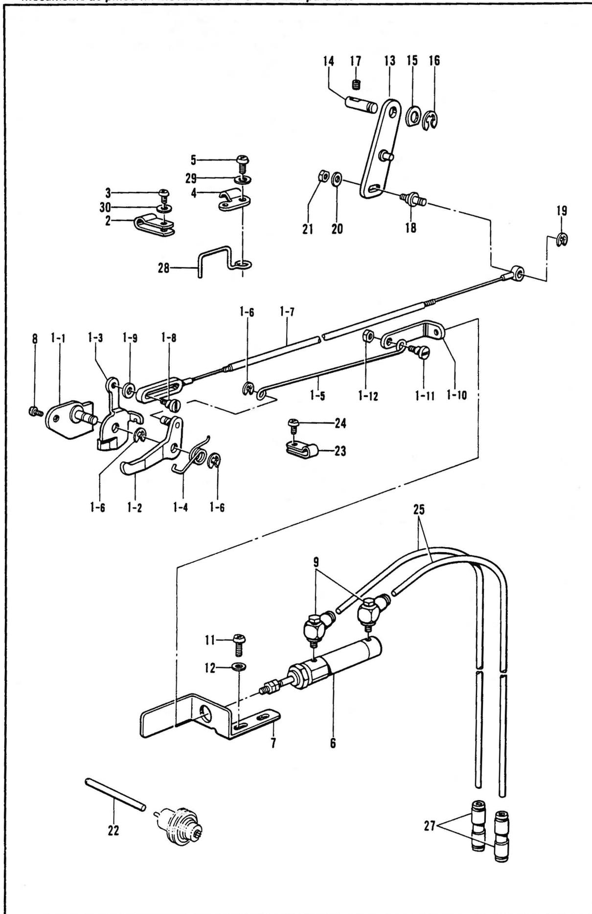
P. 糸締メ関係/Thread nipper mechanism/Fadenspannvorrichtung/
