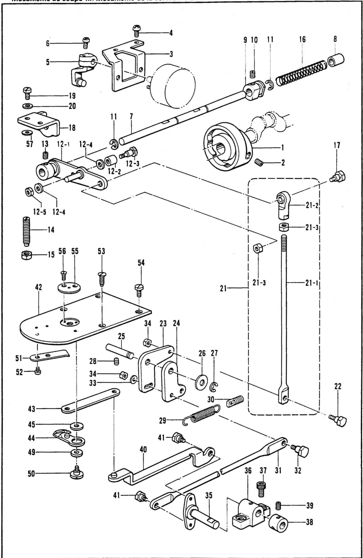
L. 糸切り関係/Thread trimmer mechanism/Fadenabschneidevorrichtung/
