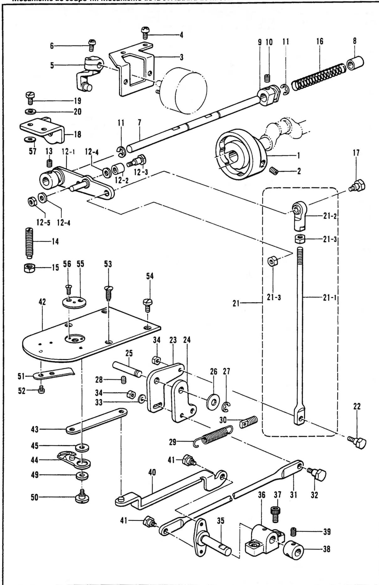
L. 糸切り関係/Thread trimmer mechanism/Fadenabschneidevorrichtung/
