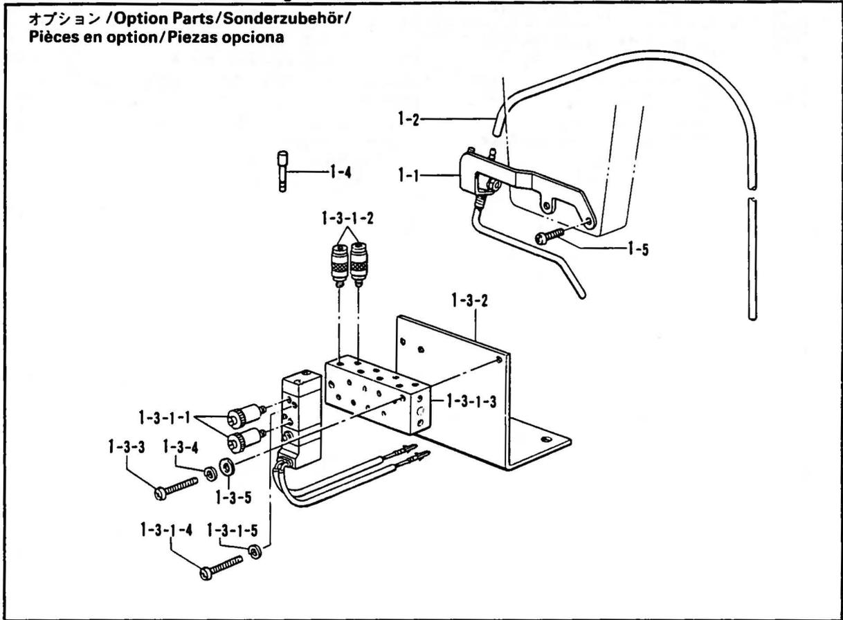
Y. 針冷却装置 / Needle cooler / Nadelkühlungsvorrichtung /
