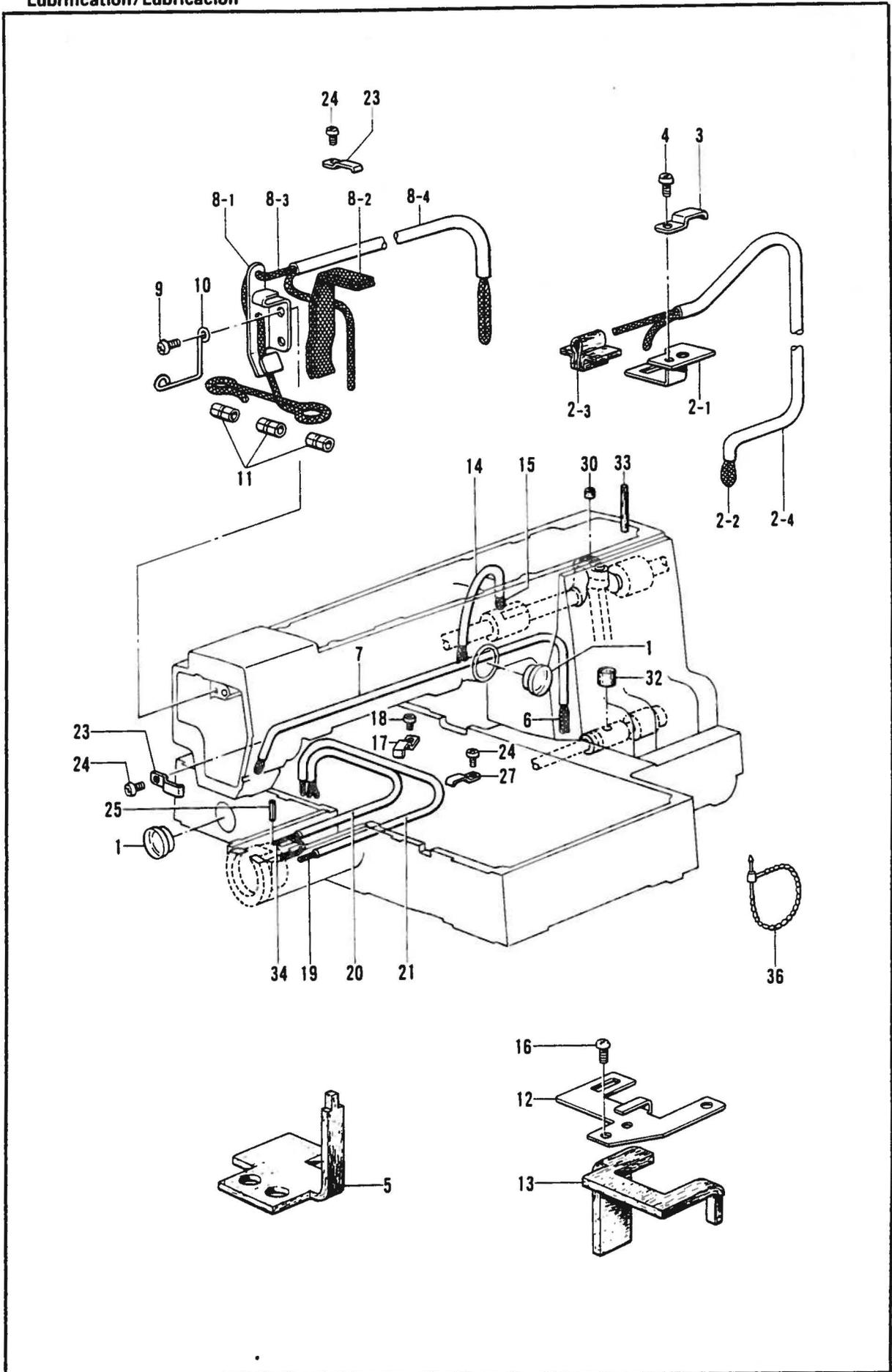
H. 給油潤滑関係/Lubrication/Schmierung/
