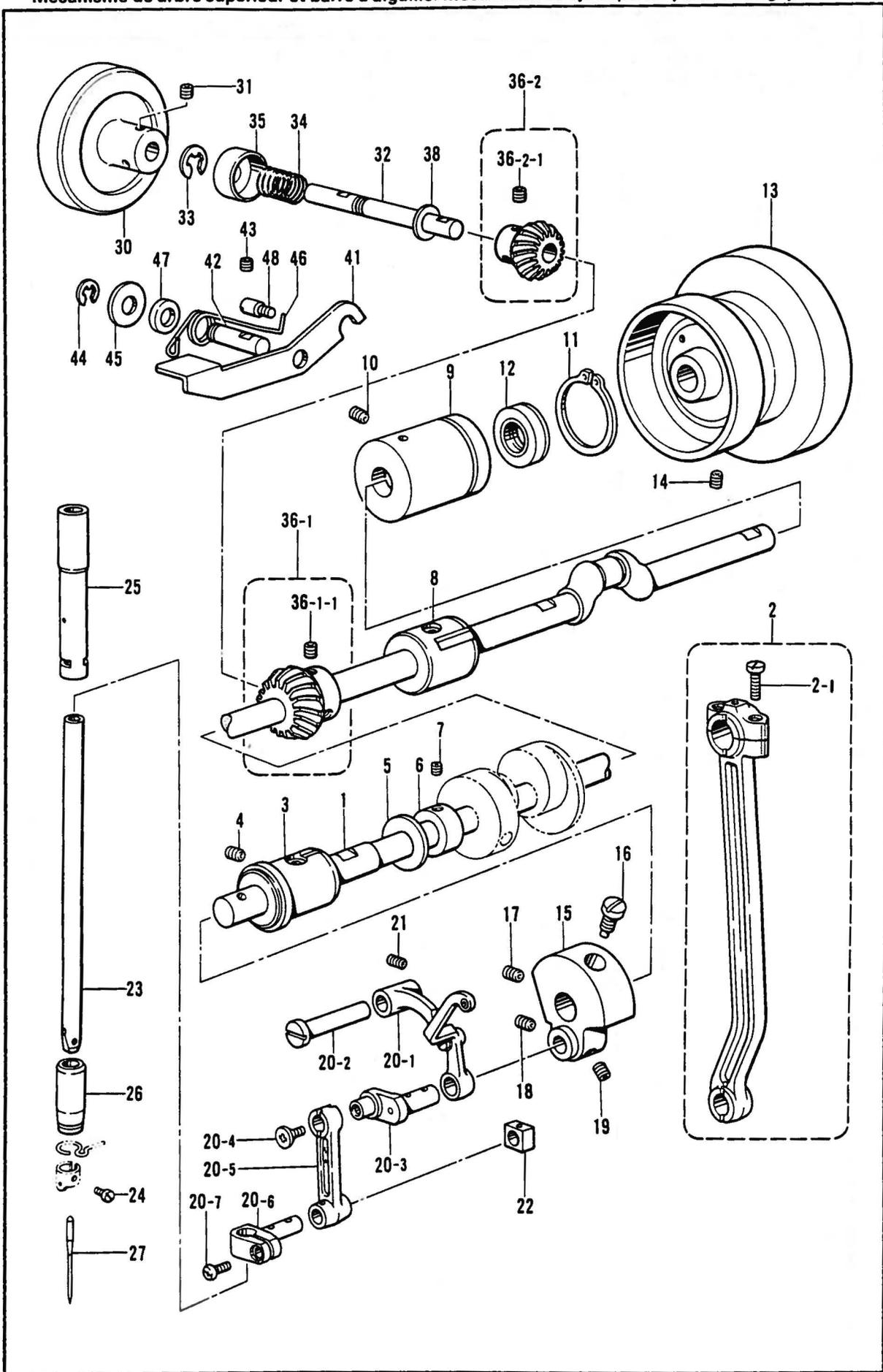
C. 上軸針関係/Upper shaft and needle bar mechanism/Obere Welle und Nadelstangenvorrichtung/
