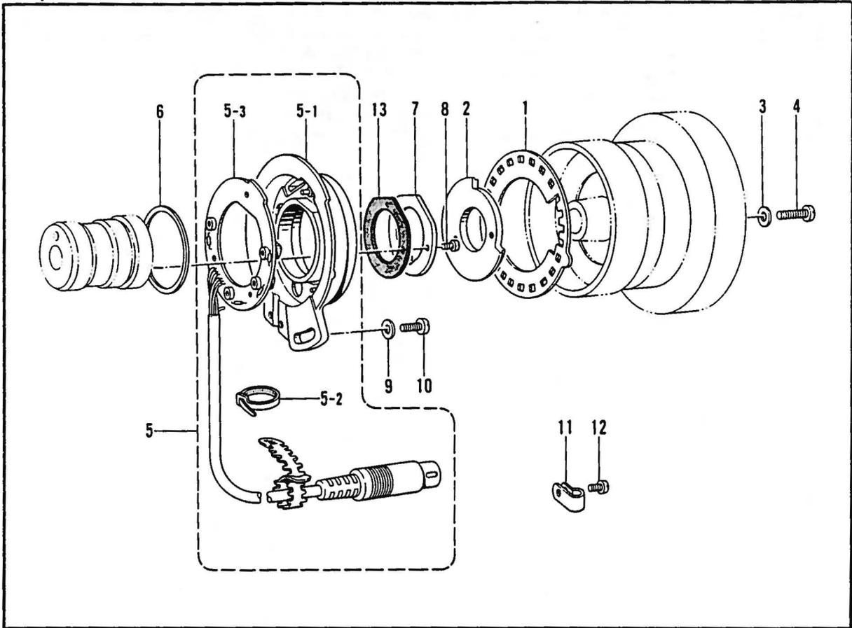
S. 踏板關係/Foot switch pedal mechanism/Fußbetätigung/
